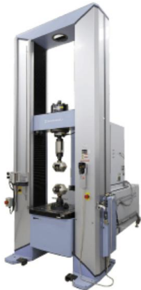
試験機 : 島津製作所製 オートグラフ AG-X
